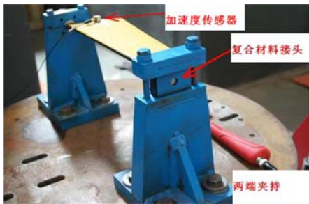
图2 叶片安装状态
