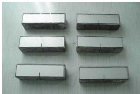
图 3 粘贴贴片后的部分试件 Fig. 3 Some specimens under coatings
