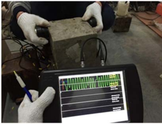
图2 混凝土损伤的超声测试
