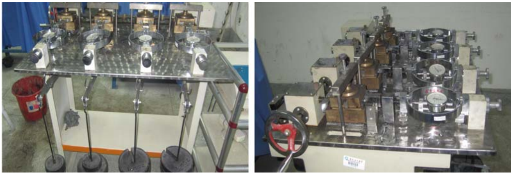
图 14 应变控制式智能电动四联直剪仪
