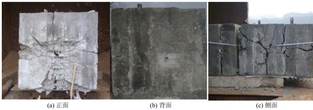
图10 实验2#靶板破坏情况
