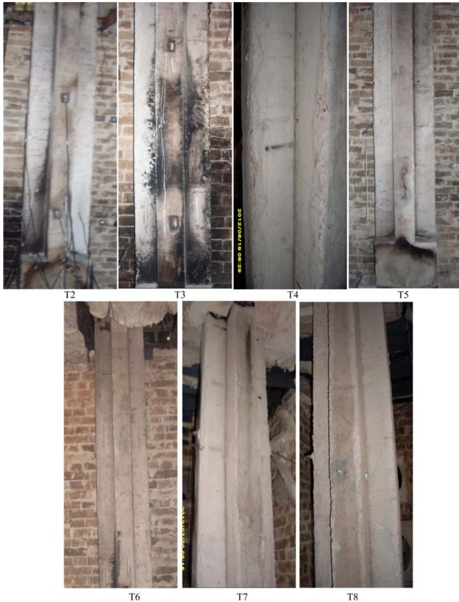
图8 火灾后试件破坏现象
