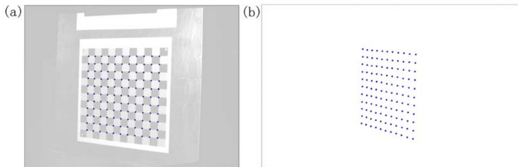
图 5 某个位置下标定板格点在(a)CCD所采集图像中和(b)投影仪中所对应的点阵
