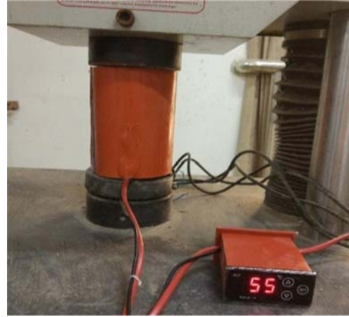
图 4 实时温控装置 Fig. 4 Real-time temperature control device
