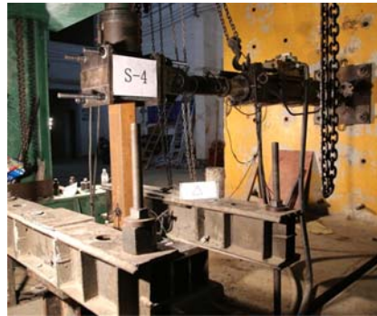
图 3 抗震试验加载装置
