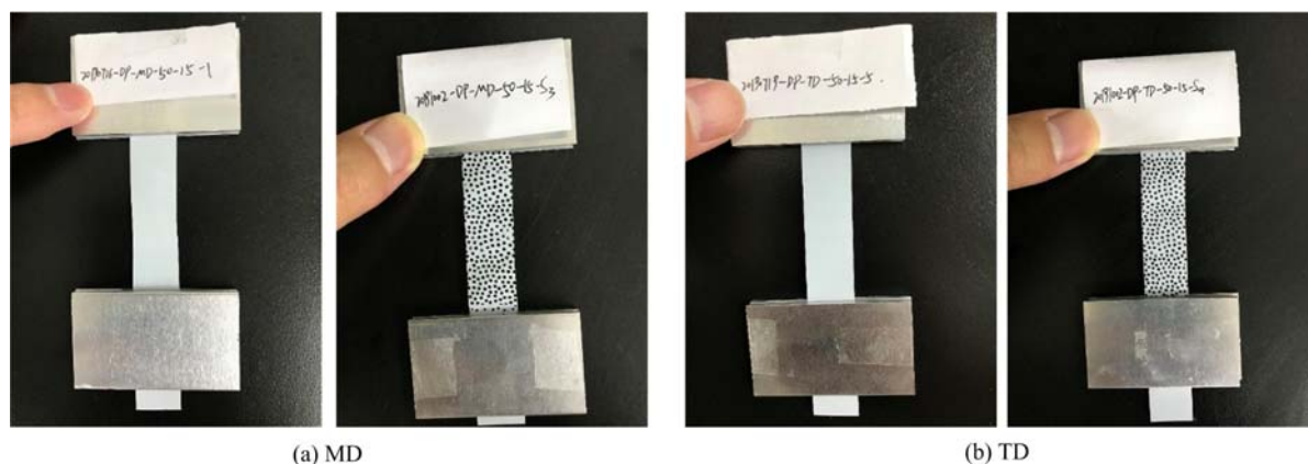
图 3 端部加固后的试件
