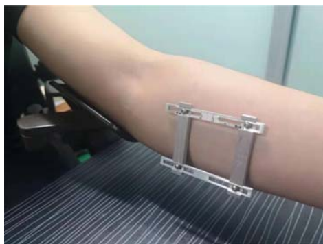
图 2 原位拉压装置示意图
