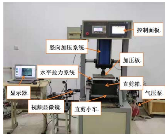
图 3 直剪试验设备
