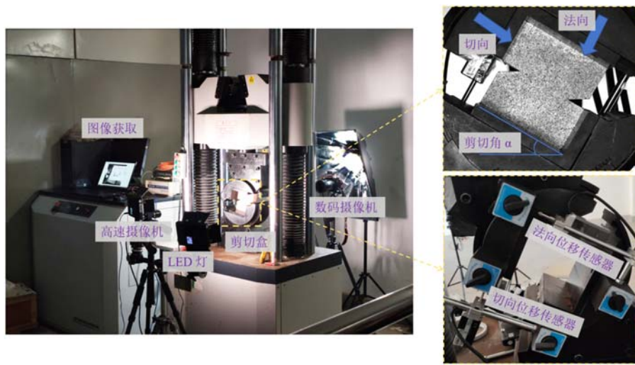
图 2 剪切盒试验系统与 DIC 测试系统
