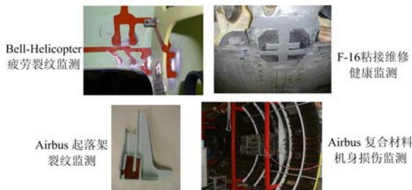
图8 智能层粘贴安装于现有结构表面
