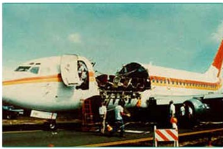
1988年阿罗哈航空公司/波音737, 机身顶部在飞行中与结构分离
