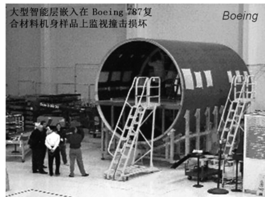
图 14 大型复合材料机身圆筒损伤监测
