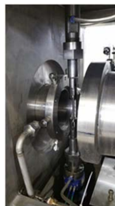
图 8 GH3039 合金样品在环境模拟实验舱中的安装位置
