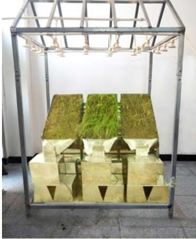
图 2 模拟降雨条件下尾矿坝植被护坡系统
