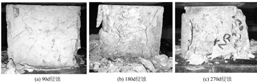
图 13 0.2% 纤维掺量试件轴压破坏情况
