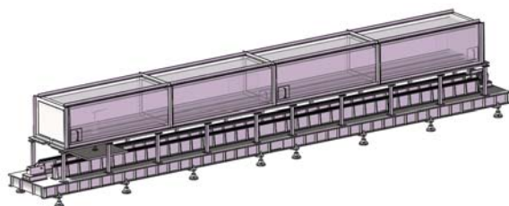
图2 极低风速标定系统结构示意图
