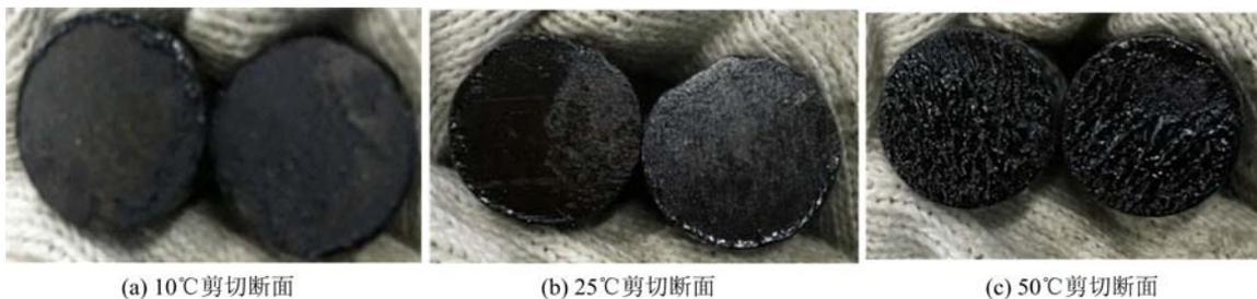
图3 不同温度剪切断面
