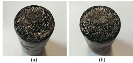
图 7 193℃ 试验 5 剪切断面图
