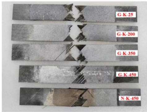
图 6 开孔拉伸破坏模式
