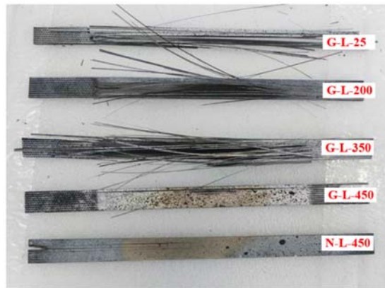
图 4 纵向拉伸破坏模式
