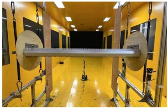
图2 主梁节段模型风洞试验布置
