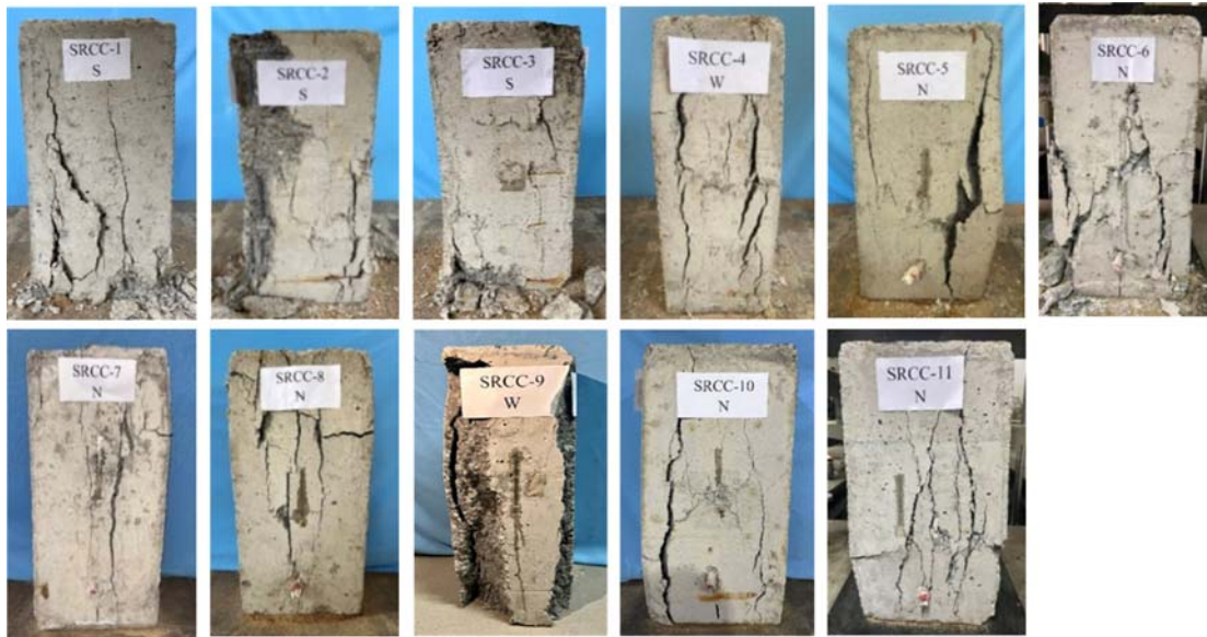
图8 腐蚀后短柱试件的轴压破坏形态
