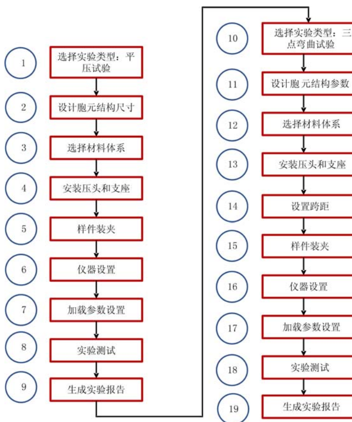
图4 点阵材料力学性能测试流程
