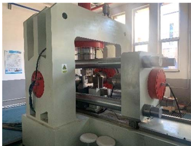
图1 QKX-YB200真三轴岩石试验机
