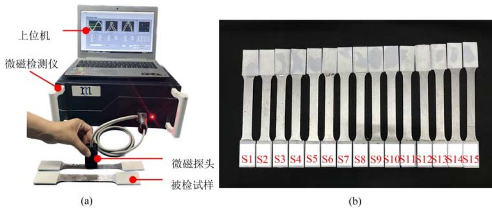
图1 (a)微磁检测仪;(b)不同塑性变形的 DH590 试样
