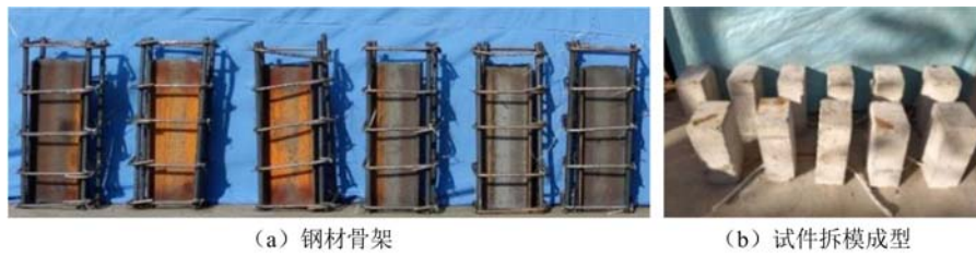
图2 型钢混凝土短柱试件的制作过程
